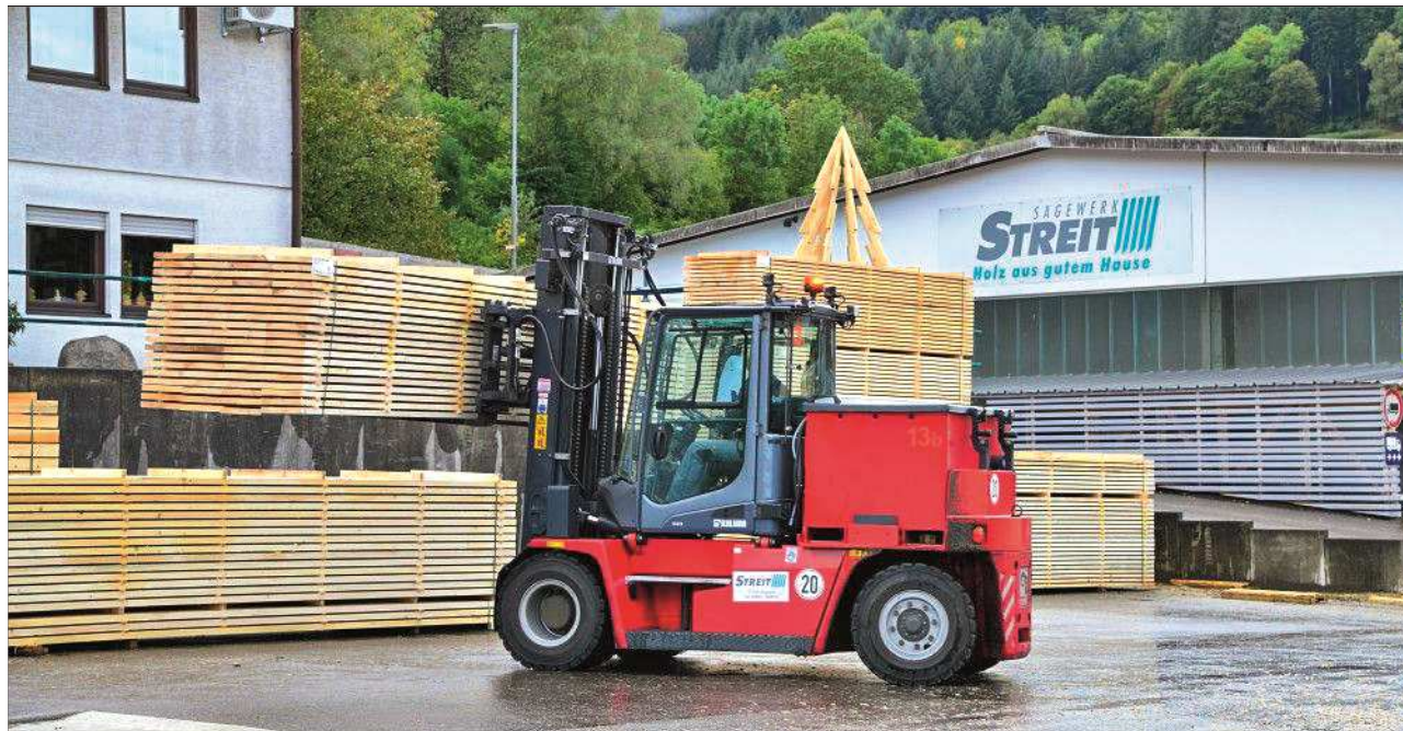
Schnittholzverladung mit Frontstaplern im Sägewerk Streit. Rund 2 000 Betriebsstunden leisten die DCE/ECF-Stapler jährlich. Die Beladung von bis zu 5 000 Lkws pro Jahr ist eine ihrer Hauptaufgaben. Foto: Kalmar
